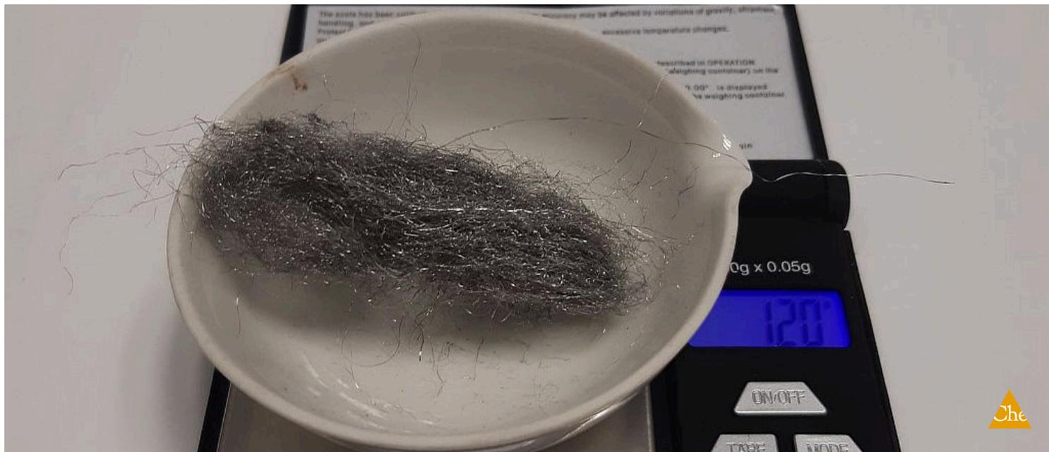
В этом эксперименте исследуется "изменение веса" при окислении. Увеличение веса при окислении металлов определяется непосредственно взвешиванием; проверяется это с помощью сжигания железной ваты.
